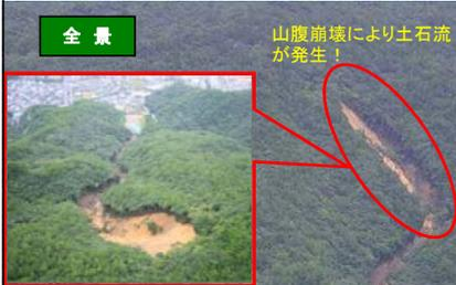
奄美市名瀬の与蓋川では、平成22年10月20日18時頃上流での山腹崩壊により土石流が発生しましたが、整備されていた砂防堰堤（高さ約12m）により、約9千m<sup>3</sup>の土石流の2/3に相当する6千m<sup>3</sup>を捕捉しました。事業所1棟と住家1戸は土砂をかぶったものの、砂防堰堤の効果により小中学校、幼稚園及び集落の住家が土石流直撃を免れ、被害を受けずに済みました。
